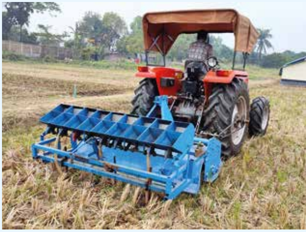
চিত্র-২: ট্রাক্টর চালিত সিডার দ্বারা ফালি চাষ
